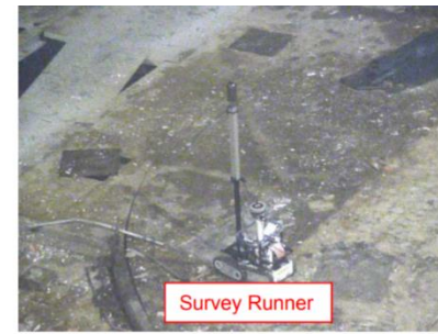
③3Dスキャンによる寸法形状測定状況
