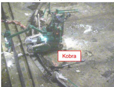
④低所表面汚染測定状況
