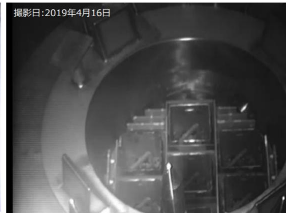
輸送容器へ燃料装填完了(7体)
