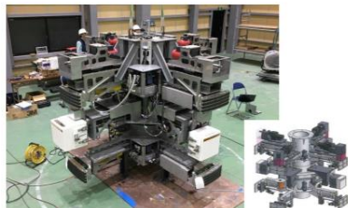
筒身解体装置 組立状況
