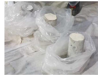
調査用コア採取状況
