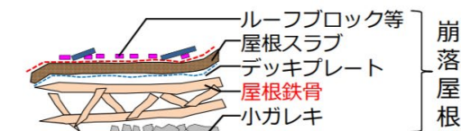
図2 崩落屋根の状態
