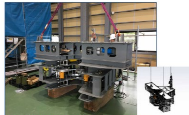
鉄塔解体装置（支柱材用）組立状況
