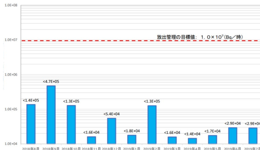
1~4号機原子炉建屋からの放射性物質(セシウム)による敷地境界における空气中放射性物質濃度の年間推移
