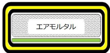
養生バッグ概略構造 (断面)
