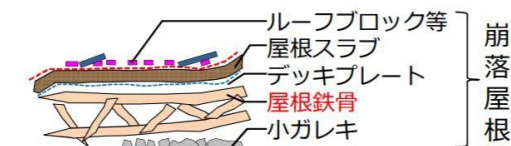
図2 崩落屋根の状態
