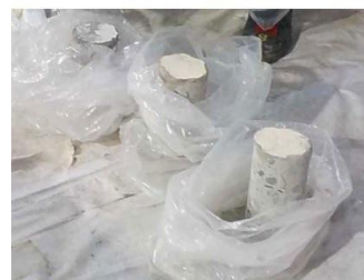
調査用コア採取状況
