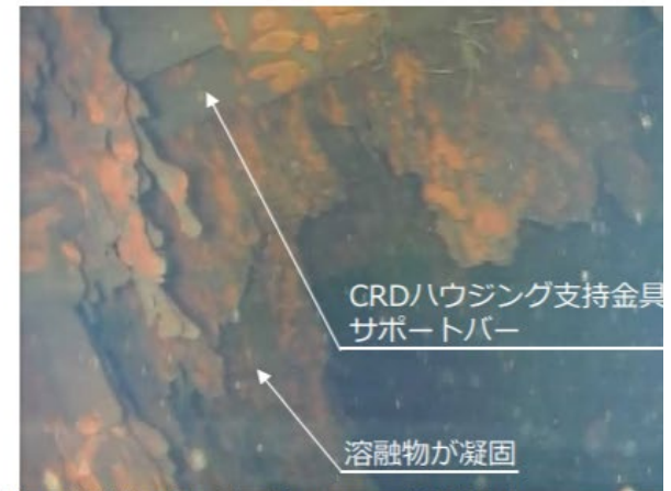
円筒状の構造物 (CRガイドチューブと推定)
