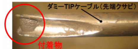
2号機 T I P 配管内閉塞物
