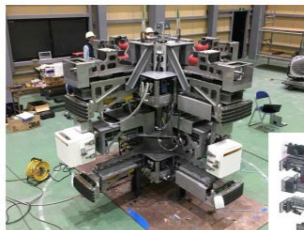
筒身解体装置 組立状況
