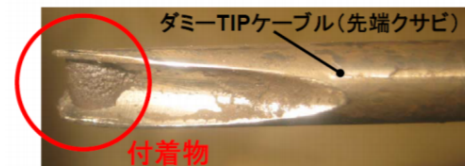
2号機 T I P 配管内閉塞物
