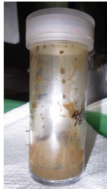
1号機格納容器底部堆積物
