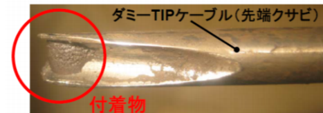
2号機T I P 配管内閉塞物
