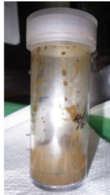
1号機格納容器底部堆積物
