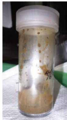
1号機格納容器底部堆積物
