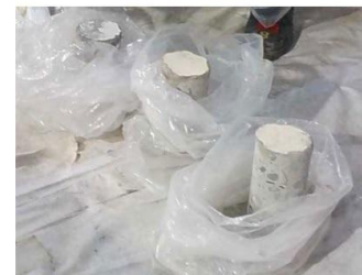
調査用コア採取状況
