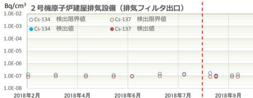
排気フィルタ入口・出口のダスト濃度測定状況
