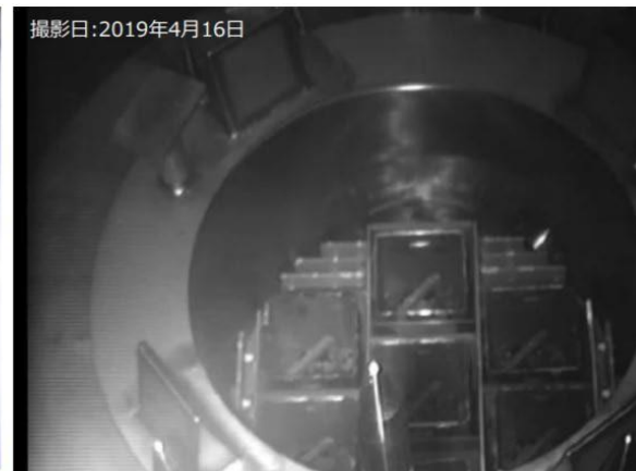
輸送容器へ燃料装填完了(7体)
